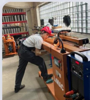
ПРОДОЛЬНАЯ СВАРКА ОГNETУШИТЕЛЕЙ
