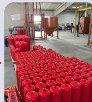
УЧАСТОК НАПОЛНЕНИЯ ОГNETУШАЩИМИ ВЕЩЕСТВАМИ
